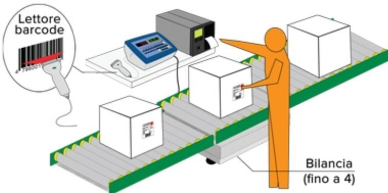
Software adatto per applicazioni di etichettatura / prezzatura industriale, con gestione di merceologici, ingredienti, peso e prezzo. Possibilità di indicare sull'etichetta le informazioni riguardanti la tracciabilità, tramite le codifiche più richieste (Barcode EAN13, EAN128, ecc.). La flessibilità di configurazione permette di soddisfare la maggior parte delle applicazioni di etichettatura, soprattutto nell'industria alimentare. Omologabile CE-M (OIML R-76 / EN 45501).
