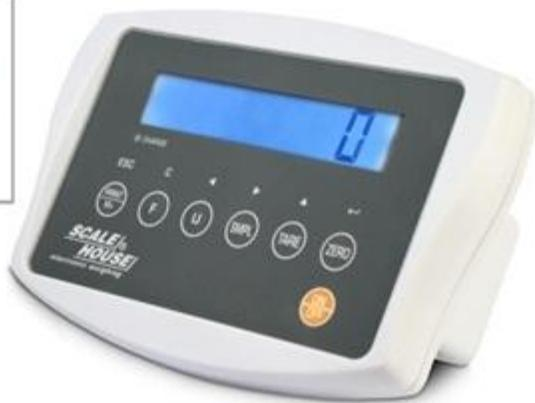
Indicatore di peso multifunzionale in ABS ad elevata semplicità di utilizzo. Collegabile a piattaforme a cella di carico; funzioni di conteggio pezzi, controllo peso e totalizzazione peso. Risoluzione interna 600.000 punti. Omologabile CE-M per uso legale in rapporto con terzi.
