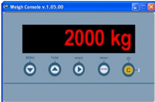
Software che permette di monitorare le pesate eseguite su indicatori serie DFW, 3590, DGT, DGTQ, DGT60, CPW, TRS, TRI.
