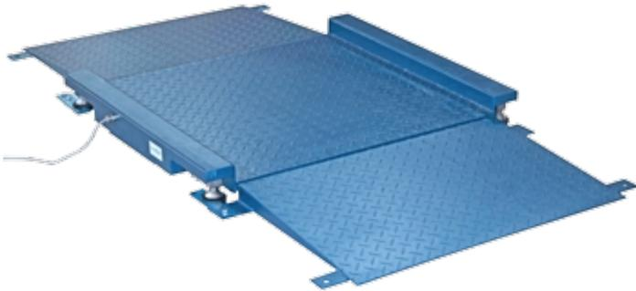
Piattaforme a profilo ribassato con rampe da 500mm e struttura e piano di carico bugnato in acciaio verniciato. Ideali per la pesatura di carrelli e transpallet grazie alla rampa di salita/discesa su entrambi i lati e alle sponde laterali. Versione standard con celle omologate.
