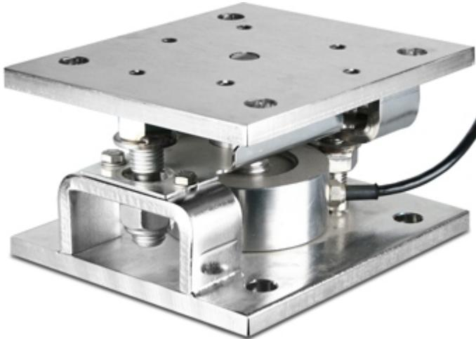
Kit di montaggio per cella a compressione serie CP: accessorio in acciaio inox progettato per la pesatura di silos, serbatoi, tramogge. E' buona norma procedere all'installazione del sistema pesato utilizzando solamente l'accessorio senza la cella.
