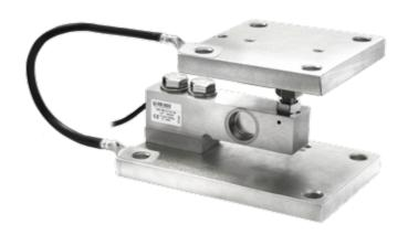
Kit di montaggio per cella shear beam serie SB...: accessori adatti per la pesatura di tramogge, serbatoi, piattaforme etc. La speciale articolazione, garantisce un'ottima precisione di misura anche in presenza di dilatazioni e/ o flessioni della struttura da pesare. E inoltre è possibile regolare l'altezza per un ottimale livellamento della struttura da pesare.
